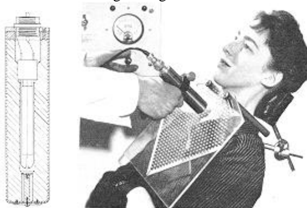
Bild 5: Exempel på manuell punktmätning över tyreoida med hjälp av scintillationsdetektor och kollimator av plexiglas [21].
