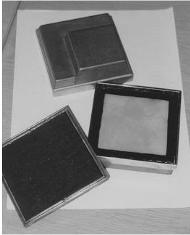
Bild 9: S. Johansson & B. Skanses gammakamera bestod av en flerhålskollimator och en scintillationsdetektor från vilken ljuset registrerades på en fotografisk film [52].
